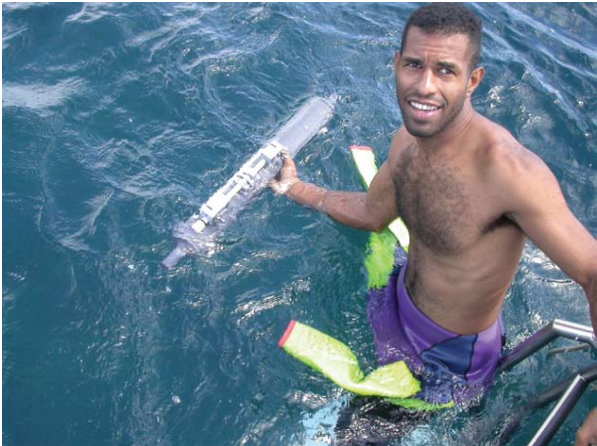
Figura 4.2. Medição dos parâmetros ambientais da Baía da Ilha Grande, RJ: garrafa Niskin (Foto: Joel C. Creed).
